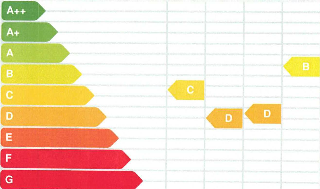
**HWB\*:** Der **Heizwärmebedarf** beschreibt jene Wärmemenge, welche den Räumen rechnerisch zur Beheizung zugeführt werden muss. Die Anforderung richtet sich an den wohngebäudeäquivalenten Heizwärmebedarf.
